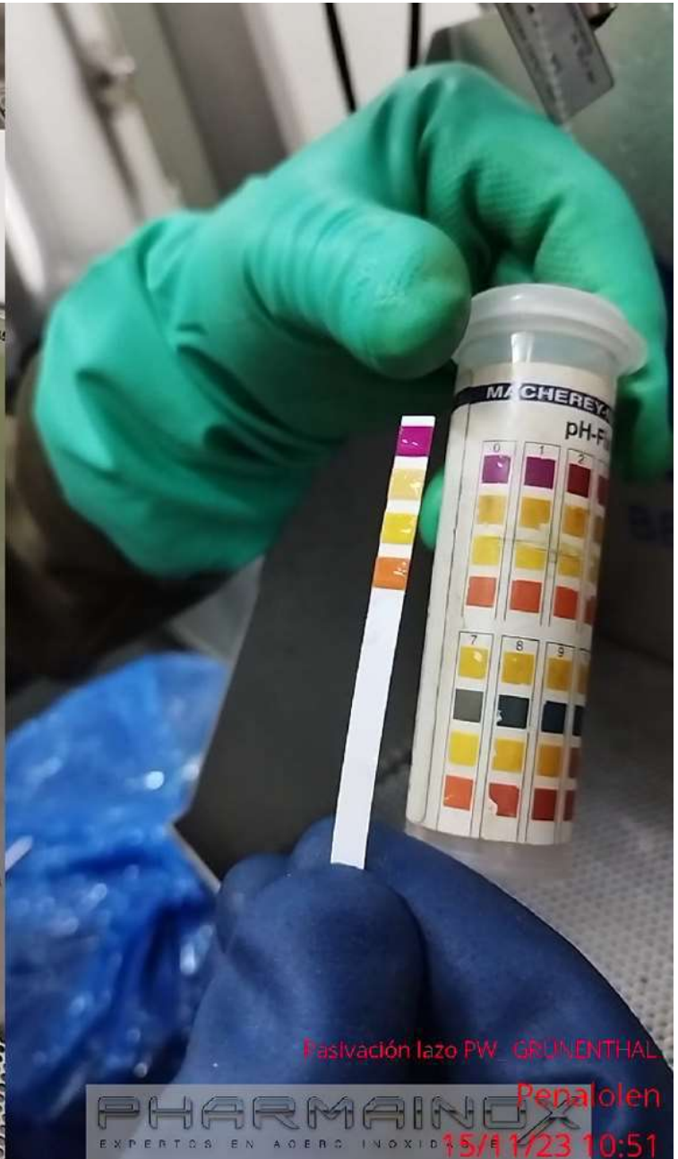
Medición de pH de la solución pasivante al interior del Lazo PW.
