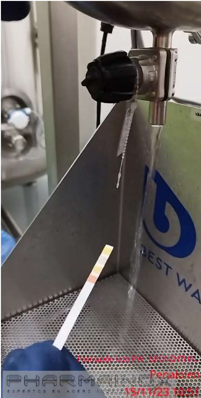
Medición de pH de la solución pasivante al interior del Lazo PW.
